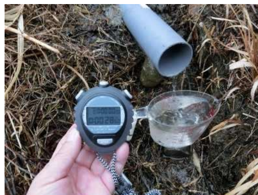
後法 漏水量測定(近景)
