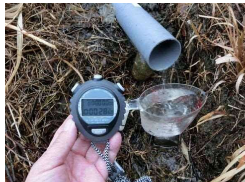
後法 漏水量測定(近景)
