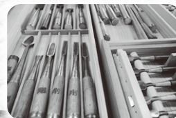
鑿(のみ) 木材、石材の加工に用いる 叩きのみと突きのみがある。
